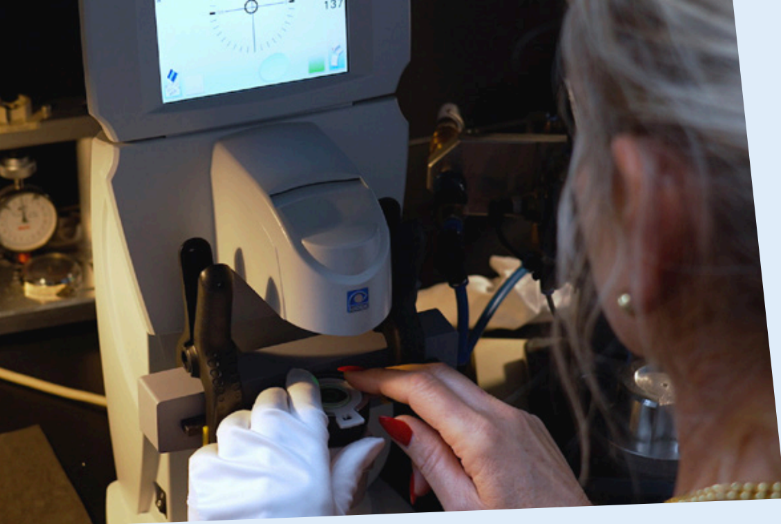
Ausrichtung von Prismen & Zylindern in der Fassung
